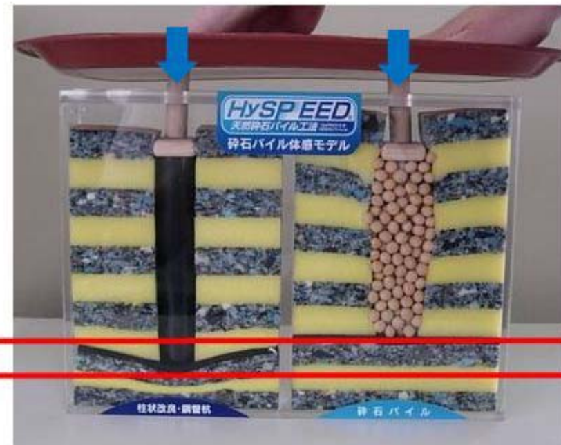
セメント柱状改良体 砕石パイル
